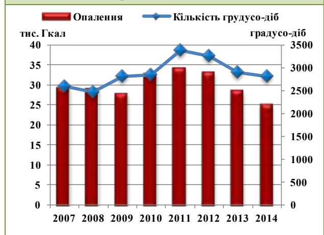
Рисунок 2.2.2. Споживання теплової енергії від системи централізованого теплопостачання
