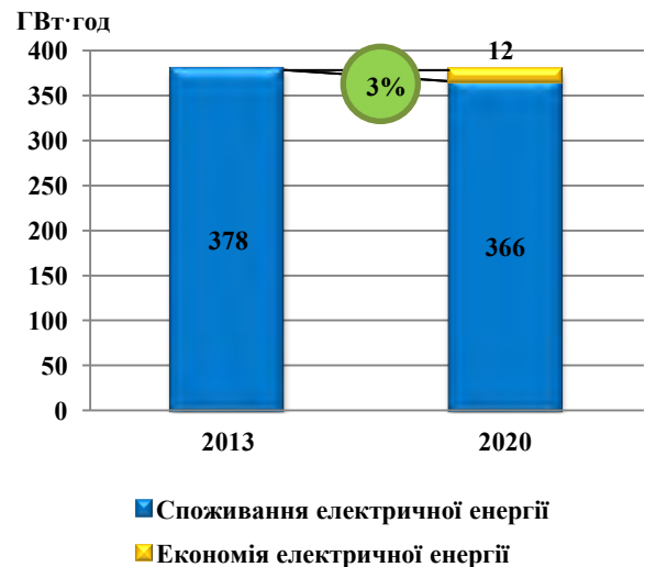
Рисунок 3.4.1. Зниження споживання електричної енергії в системі водопостачання та водовідведення
