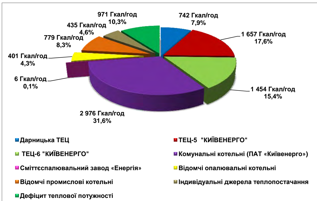
Рисунок 2.1.3. Баланс теплового навантаження основних джерел теплової енергії
