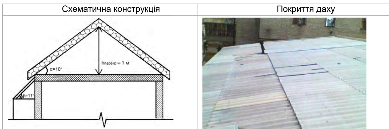
Рисунок 4.4.1. Тип даху будівлі офісу та прибудови
