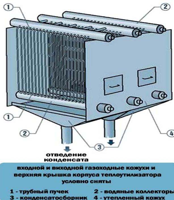
Малюнок 1.3.2. Загальний вид теплоутилізатора до котла ПТВМ-30
