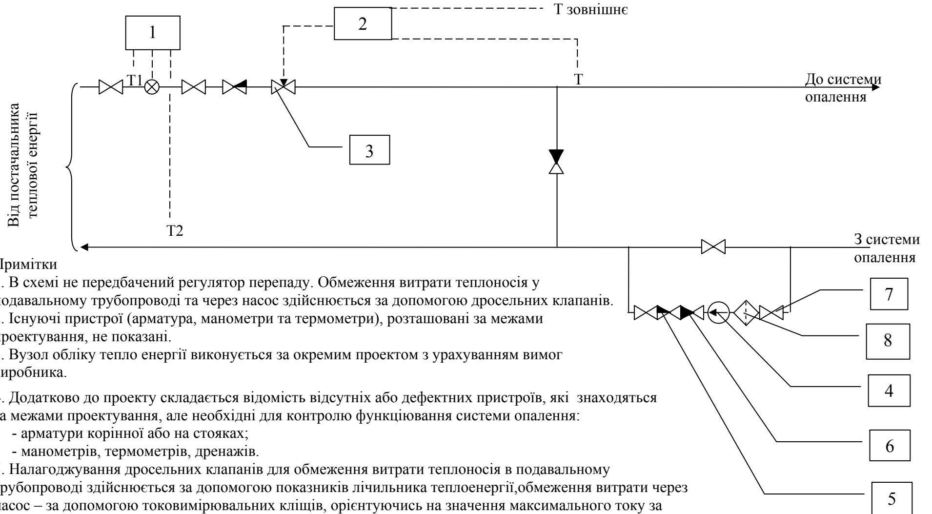
Мал. 9.1. Пропонована схема автоматики погодного регулювання з циркуляційним насосом.
